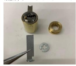
③金色のピンを上からピンセットで押さえながら、リテーナリング(金色内側ギザ)を時計方向に止まるまで回してください。まずはこれ以上締まらないという所まで締める。
